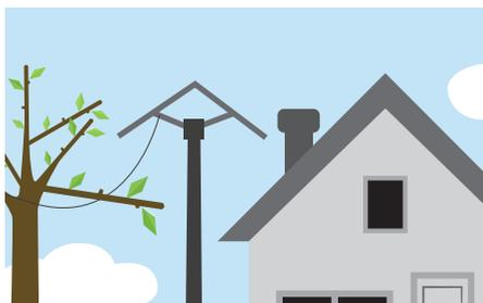
Une branche touche un câble électrique. L'ensemble du quartier constate alors des micro-coupures pouvant endommager les appareils électriques.
